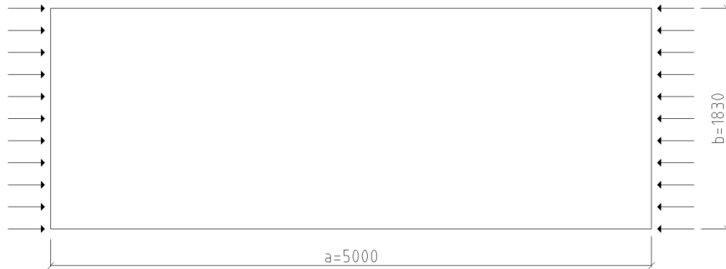
Figura 94 – Placa (verificação da estabilidade da alma ao enfunamento segundo as normas F.E.M.)
