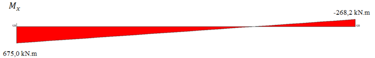
Figura 115 – Momento fletor M_x para a ligação superior (verificação da resistência à flexão composta com compressão – EC3).
