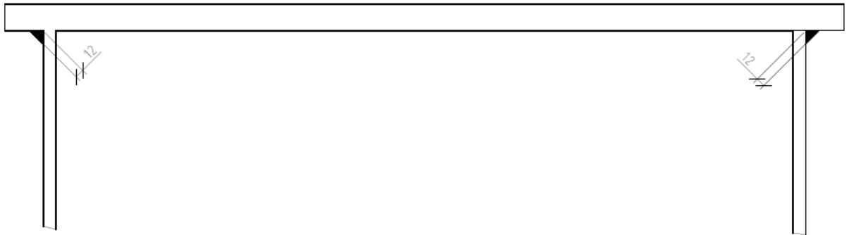
Figura 139 – Pormenor dos cordões de soldadura (travessas superiores/inferiores entre planos de pórtico)
