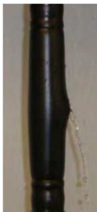
Figura 5.5 – Exemplo de rotura em tubagem termoplástica, por excesso de pressão (imagem obtida nos laboratórios da Geberit, na Suíça) (Russo,2009).
