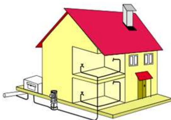
Figura 3.5 – Sistema indireto com bombeamento direto (Medeiros,2012).
