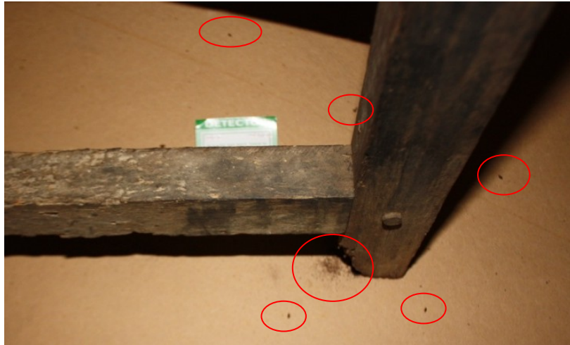
FOTOGRAFIA N° 5. Colocação da armadilha junto de um objeto em madeira, com indícios da presença ativa de ataque de insetos xilófagos (SOARES. MMP, 2011).
