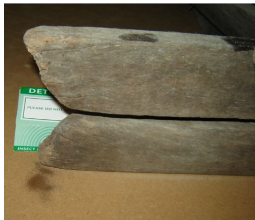
FOTOGRAFIA Nº2. Zona de colocação de uma armadilha, devido à presença de serrim, como se pode observar na imagem (SOARES. MMP, 2012).
