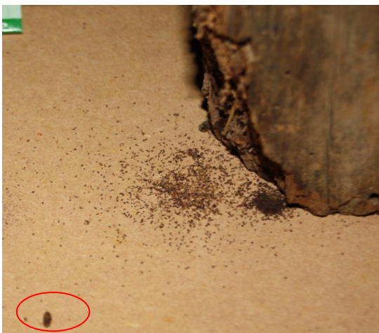
FOTOGRAFIA N° 6. Registo fotográfico da presença de serrim na superfície da estante, junto da perna do objeto, acondicionado na reserva do MMP (SOARES. MMP, 2011).
