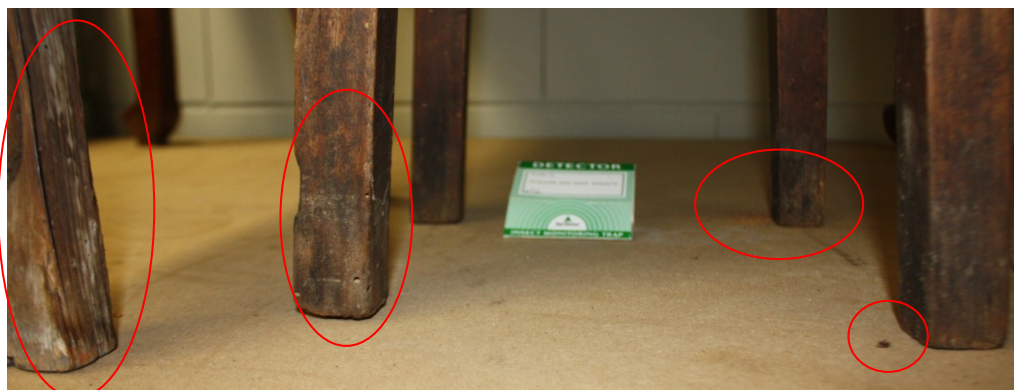
FOTOGRAFIA Nº12. Colocação das armadilhas junto de objetos com patologias referentes a possível ataque ativo de insetos xilófagos (SOARES. MMP, 2011).
