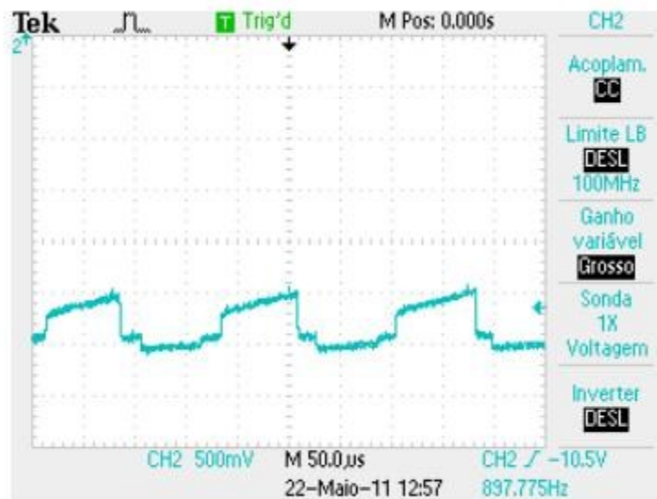
Figura 3.6 - Ondulação da tensão da fonte de -12V
