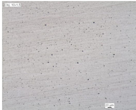
Fig. 52 - Fotomicrografia da superfície polida das peças produzidas a partir das misturas OptiMIM B52 e B53, tendo a extracção aquosa do ligante sido realizada no CTCV e o resto do processamento na DURIT segundo o ciclo térmico CT OptiMIM.
