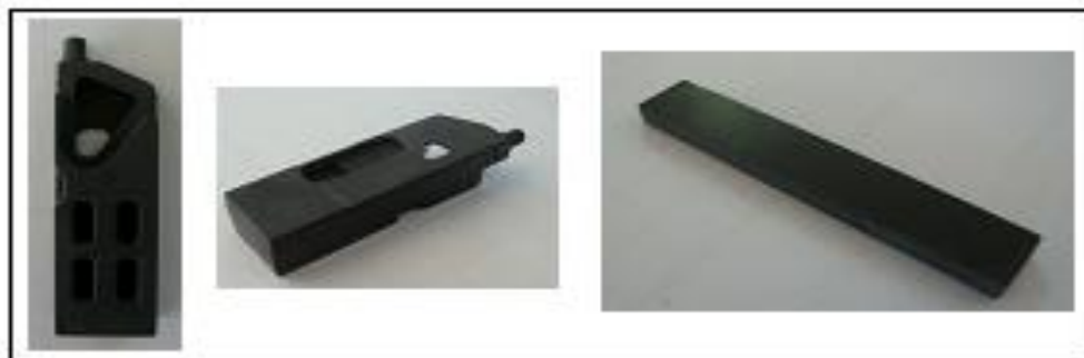
Fig. 31 - Fotografias de uma barra e de um pivot em verde.
