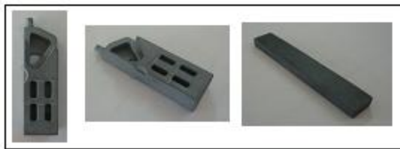
Fig. 39 - Fotografias de um pivot e de uma barra após sinterização.
