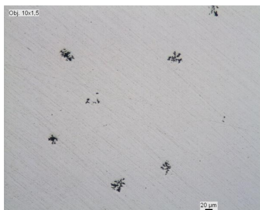
Fig. 40 - Fotomicrografia da superfície polida de uma peça produzida a partir da mistura PolyMIM, tendo a extracção térmica e a sinterização ocorrido, em processo contínuo, segundo o ciclo térmico CT PolyMIM.
