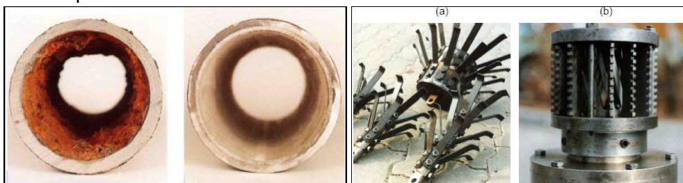
Figura 34: Técnica de revestimento com argamassa de cimento; (a) raspadores de aço; (b) dispositivo de spray para aplicação de argamassa.
