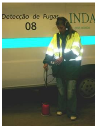
Figura 49: Utilização de um geófono para localização de uma fuga de água
