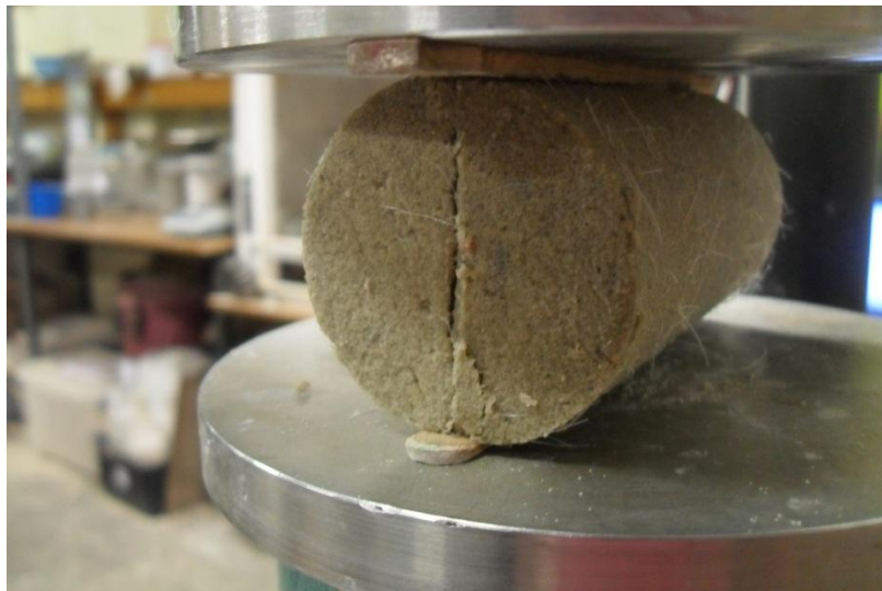
Fig. 5 57 - Modo de rotura de um provete sujeito ao ensaio de tração por compressão diametral.
