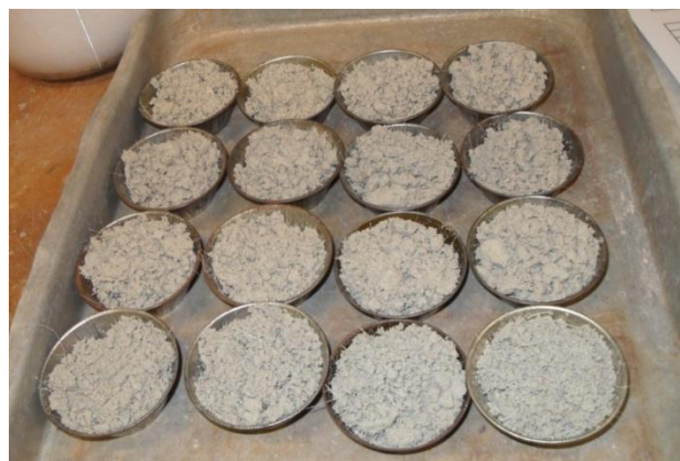
Fig. 4. 8 - -- Cápsulas retiradas da estufa.
