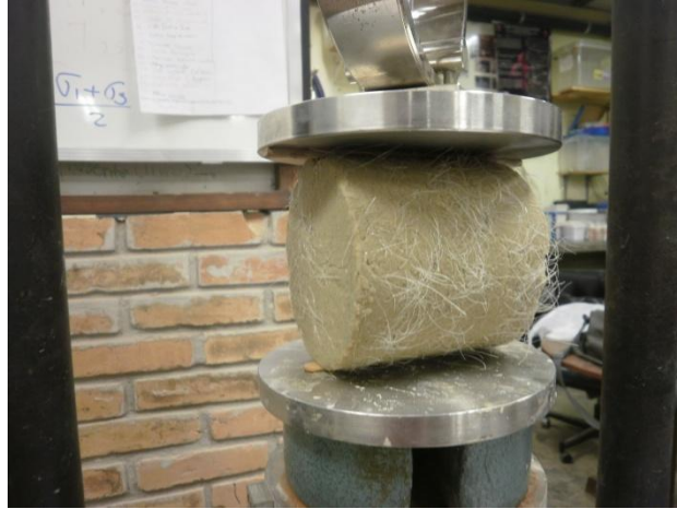
Fig. 4. 13 - Prensa e corpo de prova durante ensaio de compressão diametral.
