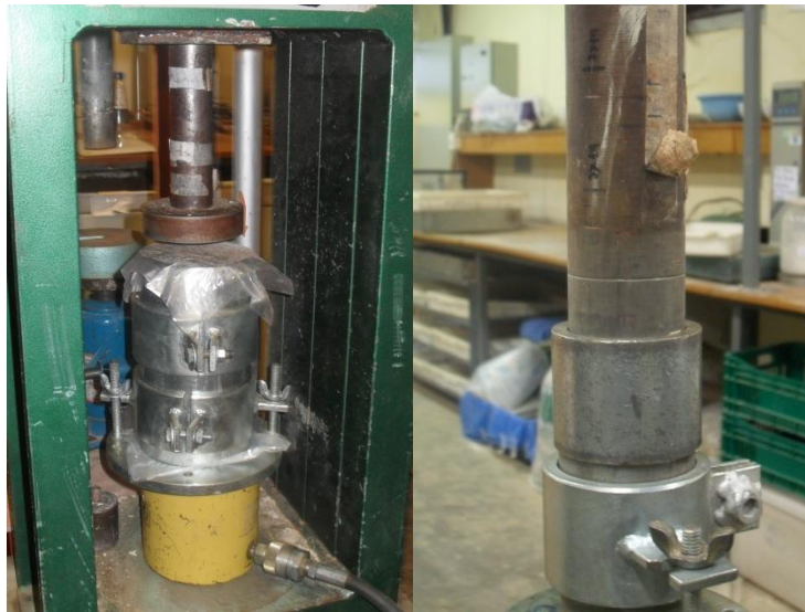
Fig. 4. 7 - Equipamento de compactação para as duas dimensões dos moldes.
