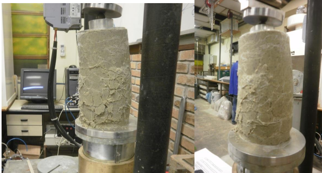
Fig. 5 54 - Provete durante o ensaio de compressão simples, l/d=500 , e=0,62 e 5% de cimento.
