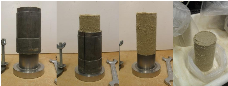
Fig. 4. 9 - Fases de desmoldagem e acondicionamento para os provetes de dimensões de 50x100mm.
