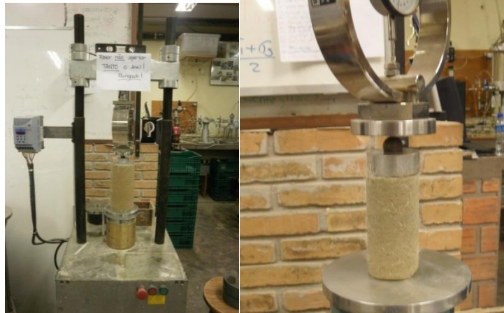
Fig. 4. 10 - Prensa e corpo de prova num ensaio de compressão simples.
