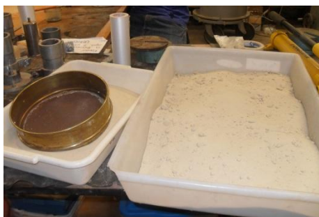
Fig. 4. 4 - Secagem ao ar, destorroamento e envolvente
