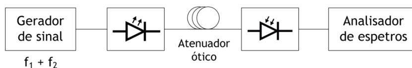
Figura 5.38 - Diagrama de blocos para a medição experimental da SFDR no caso analógico
