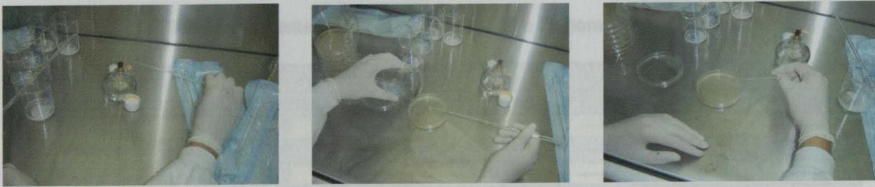
Figura 21 – Da esquerda para a direita: dobragem da pipeta à chama(espalhadores); colocação do Bonelike<sup>®</sup> em solução na placa de Petri; Espalhamento da solução na placa com meio de cultura nutriente Agar.
