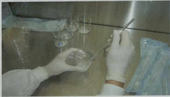
Figura 20 – Diluição dos pós em água esterilizada.
