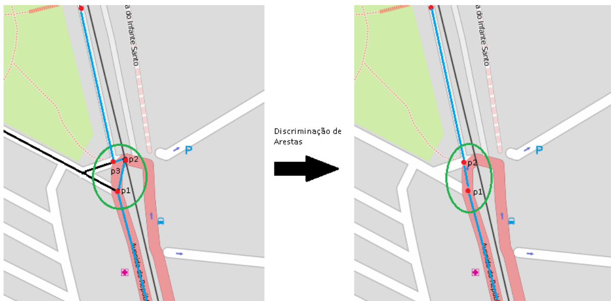
Figura 4.5 - Exemplo do funcionamento da discriminação de arestas
