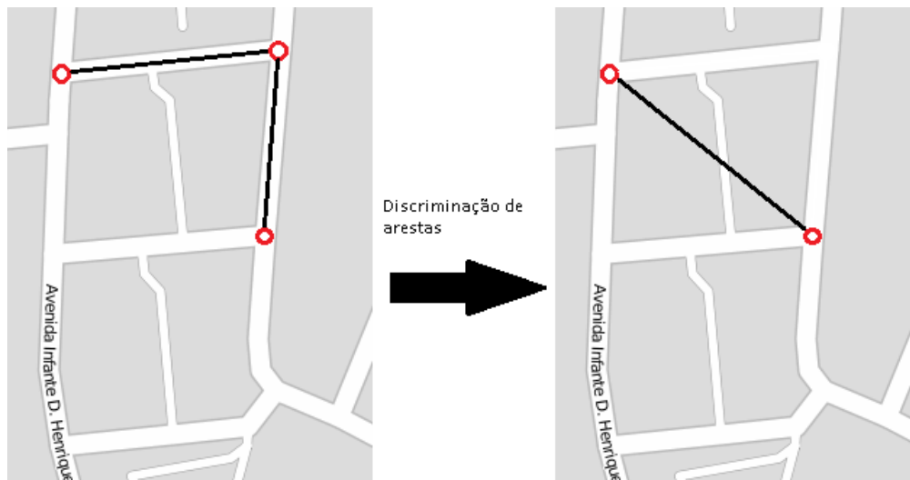
Figura 4.7 - Exemplo do problema resultante da discriminação de arestas
