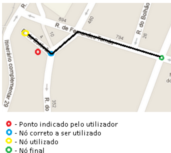
Figura 4.4 - Erro na técnica da aresta mais próxima
