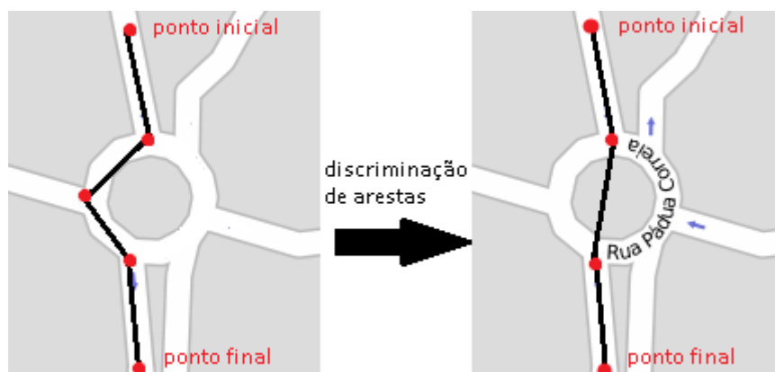
Figura 4.6 - Exemplo da discriminação de arestas numa rotunda pequena
