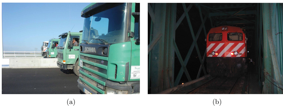
FIGURA 1.5: Vistas gerais de ensaios de recepção recentes: a) Ponte da Lezíria (Rodrigues et al., 2007); b) Ponte Eiffel (Cavadas et al., 2008).
