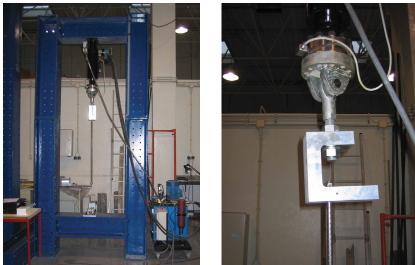
FIGURA 5.8: Diferentes perspectivas do esquema de ensaio adoptado para calibração dos transdutores de deformação através da aplicação de uma carga cíclica de tracção uniaxial.
