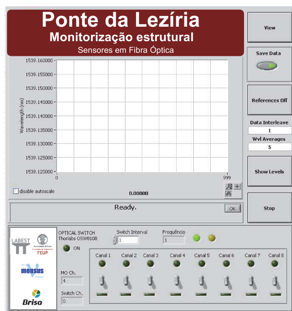
FIGURA 7.21: Aplicação informática para controlo do sistema de interrogação óptico.
