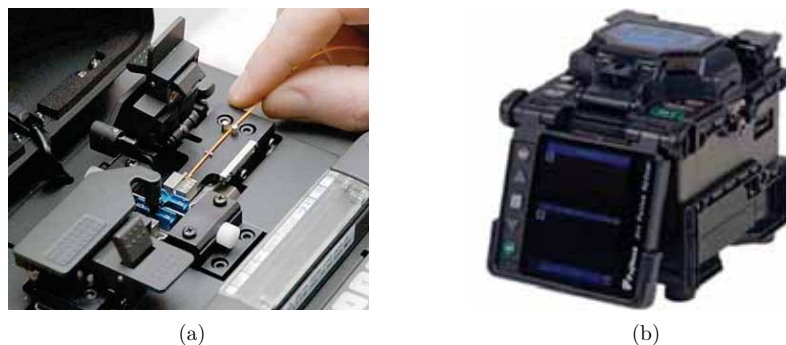
FIGURA 2.45: Processo de emenda de fibras ópticas por fusão: a) equipamento de fusão; b) disposição da fibra óptica no equipamento para fusão.
