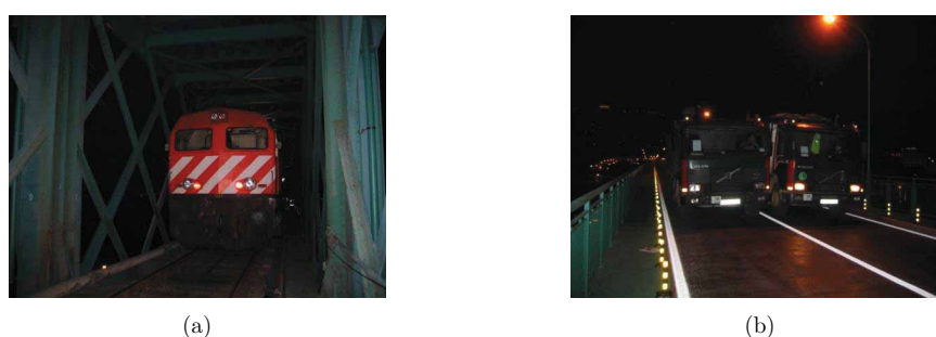
FIGURA 3.45: Veículos em marcha lenta durante o ensaio de carga: a) locomotiva ferroviária (121 ton.); b) camiões rodoviários a par ( 2 \times 30.2 ton.).
