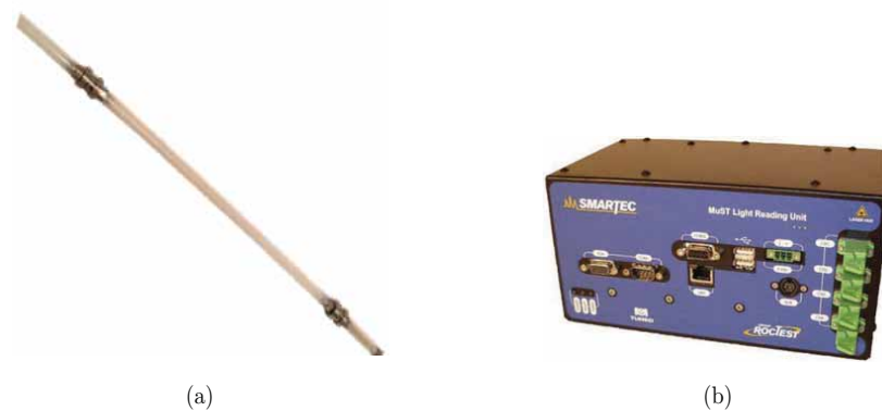
FIGURA 4.12: Sistema MuST: a) transdutor de deformação; b) unidade de leitura MuST light
