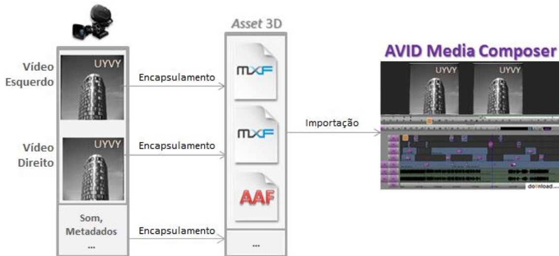
Figura 27: Fluxo de etapas para importação de um asset 3D para o Media Composer
