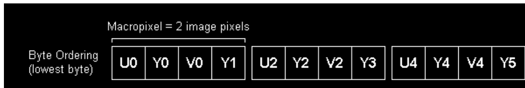
Figura 21: Organização estrutural de um bloco de pixeis UYVY
