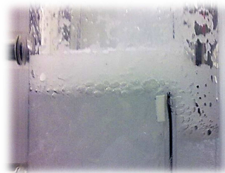
Figura 21: Tampão originado pelas partículas sólidas no lado do downcomer
