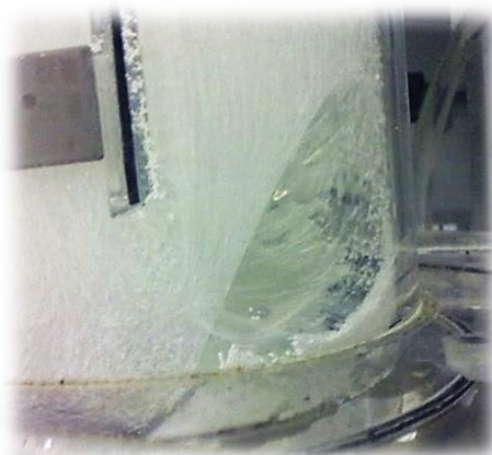
Figura 6: Peça colocada na base do downcomer
