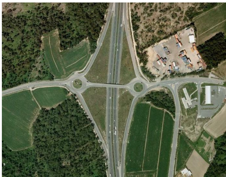
Figura 4.3. – Exemplo de um Nó em Diamante com duas rotundas na estrada secundária (Fonte: Google Maps 2012)
