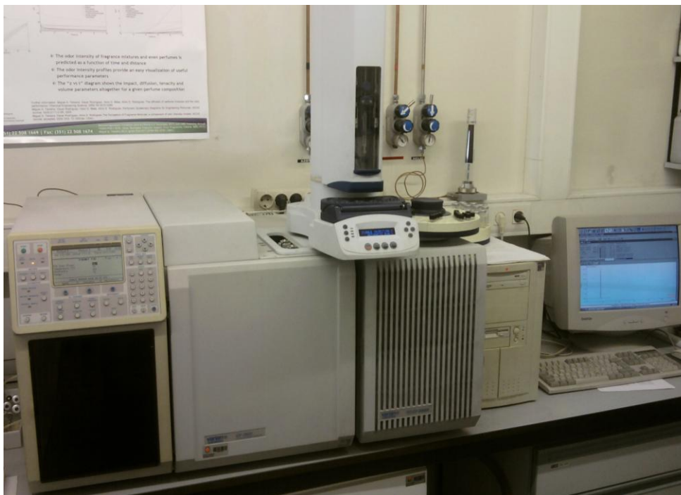
Figura 9 - Foto do cromatógrafo gasoso com espectrometria de massa (GC-MS) utilizado no LSRE.
