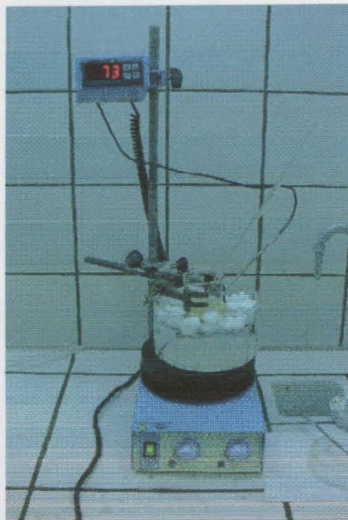
Figura 3.2.1 Montagem experimental da preparação da solução de colagénio.
