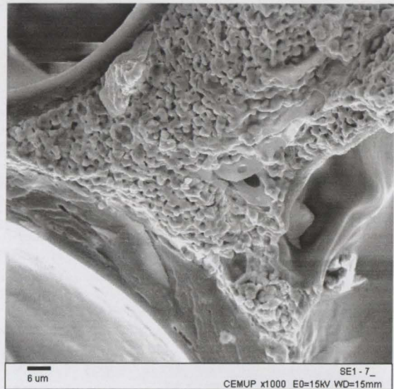
Fig. IVk Interior do compósito submetido à temperatura de 140°C durante 24horas. (1000X)
