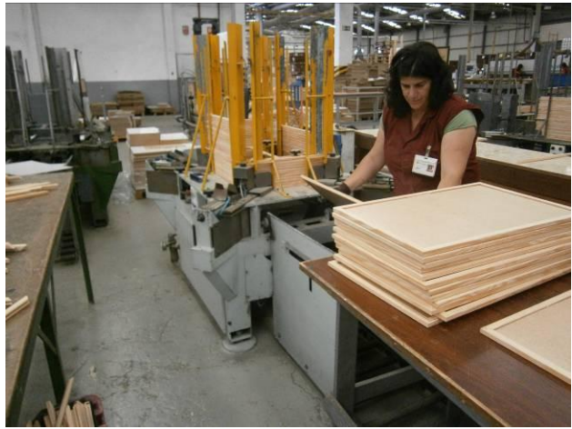
Ilustração 36: Inspeção do produto à saída da máquina (antes e depois).
