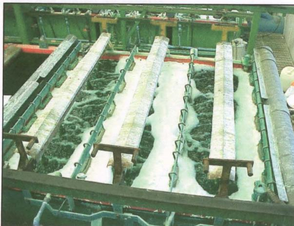
Fig.1 – Tina do banho de Níquel com capacidade para 3 suspensões em simultâneo.
