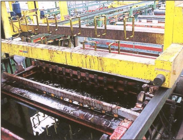
Fig.2 – Saída de uma suspensão do banho de Crómio
