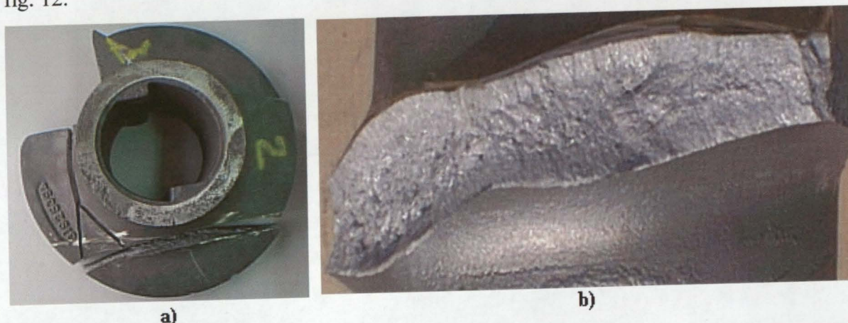
Fig. 12 – Peça 2. a) Corte pelos pontos quentes. b) Corte no ponto quente não apresentando rechupes.
