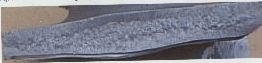
Fig.8 – Corte da peça 1 por um dos pontos quentes, não se visualizando qualquer rechupe.
