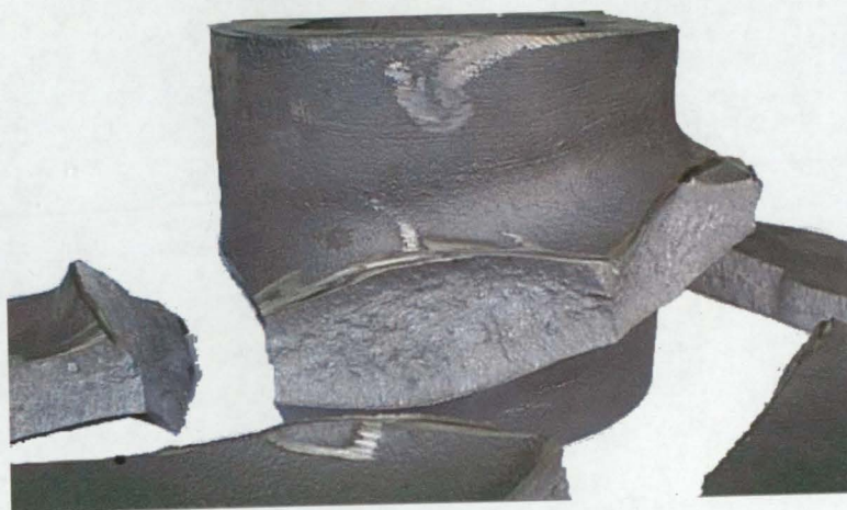
Fig.14 – Peça 3 cortada nas zonas correspondentes aos pontos quentes, não evidenciando qualquer rechupe.
