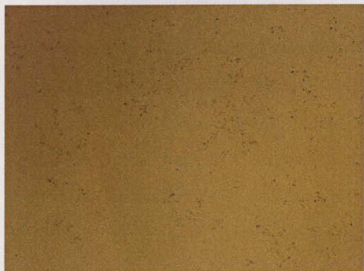
Fig. 50.- Porosidade tipo C; BD10 prensado uniaxialmente a 1200 bar e sinterizado em forno sob vácuo.
