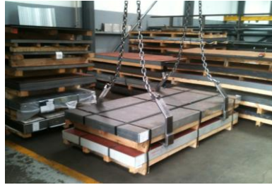
Fig. 29 Proposta de acessório para transporte de paleta de chapa
