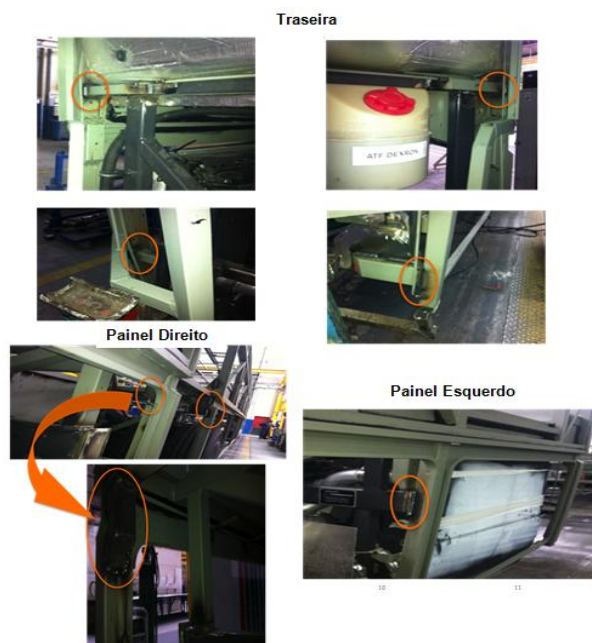
Fig. 53 Zonas onde não deve ser aplicada cola
