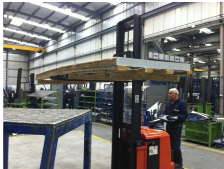
Fig. 30 Utilização de Stacker para transporte de paleta de chapa
