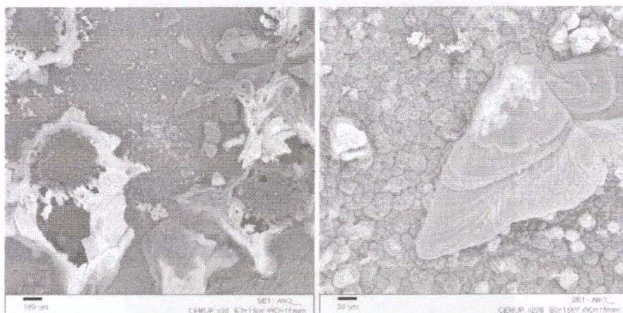
Figura 28. Micrografia da amostra 3 (8 dias de imersão), com ampliação de 30 e 200 X.
