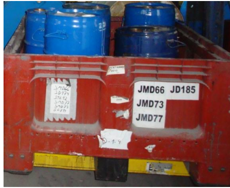
Figura 27 – Identificação das matérias-primas nos armazéns: rótulos danificados e sem normalização
