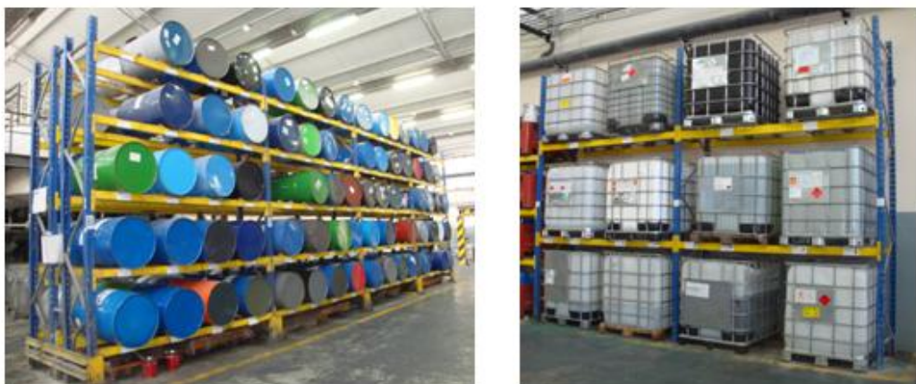
Figura 31 – Armazém matérias-primas em tambor e em contentor depois da reestruturação
