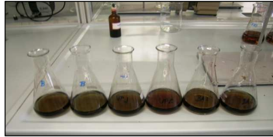
Figura 48. Amostras para determinação da CQO após a titulação.
