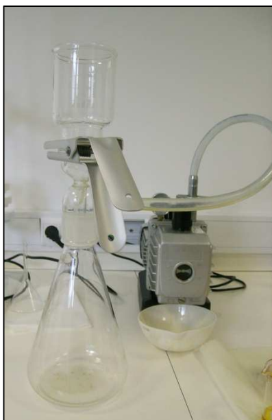
Figura 55. Sistema de filtração utilizado na determinação de SST.
