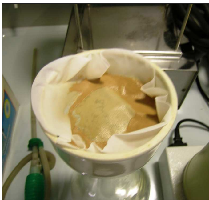
Figura 51. Filtro utilizado na determinação dos Óleos e Gorduras preparado para a filtração de uma amostra.
