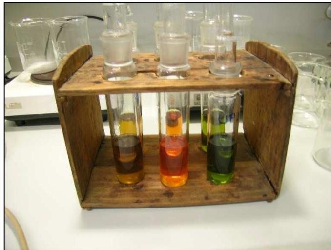
Figura 46. Amostras para determinação da CQO nos tubos digestores após digestão.
