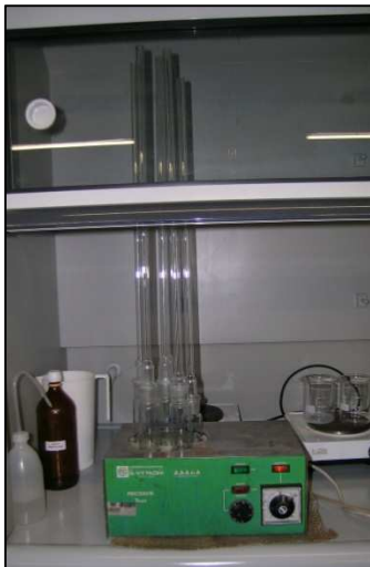
Figura 45. Amostras para determinação da CQO no digestor.
