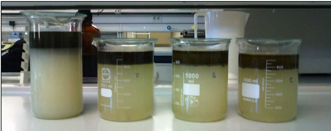
Figura 35. Amostra não acidificada (à esquerda) e amostras acidificadas com ácido fosfórico, sulfúrico e clorídrico (respetivamente) após decantação.
