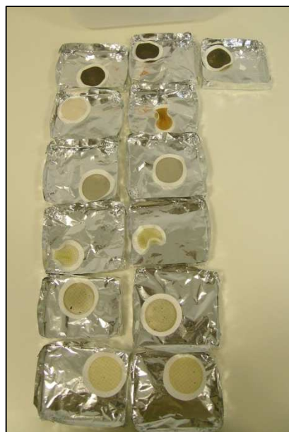
Figura 56. Filtros utilizados na determinação dos SST após filtração das amostras e secagem.
