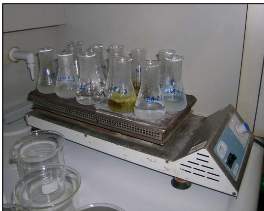
Figura 49. Amostras para determinação do Fósforo Total na placa de aquecimento.
