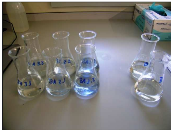
Figura 50. Amostras para determinação do Fósforo Total após formação de cor.
