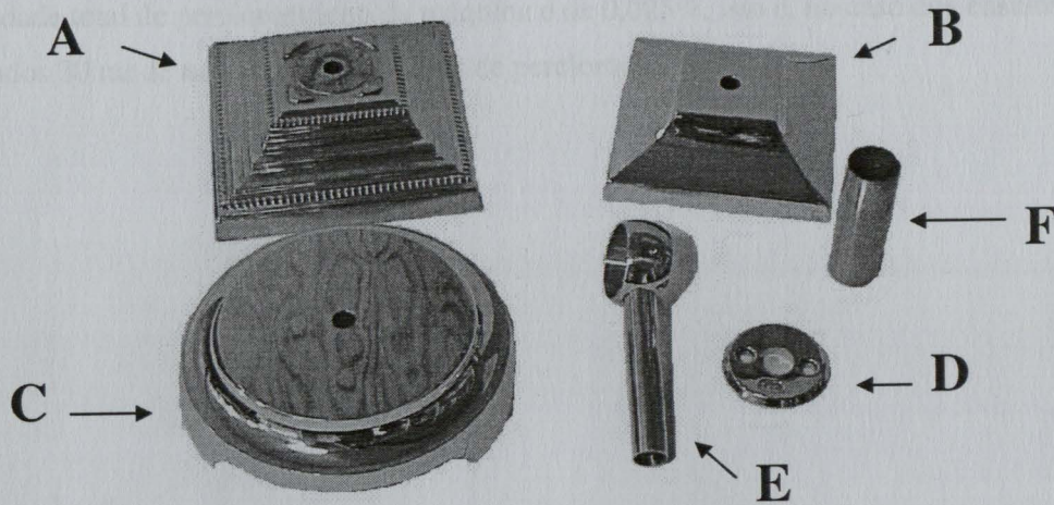
Figura 2 – Na remoção de pasta de polir: A – Base quadrada trabalhada; B – Base quadrada; C – Base redonda; D – Espelho de puxador; E – Suporte de cortinados. Na remoção de óleos de corte: F – Pontas).
