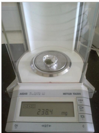
Figura 33. Medição do peso seco
