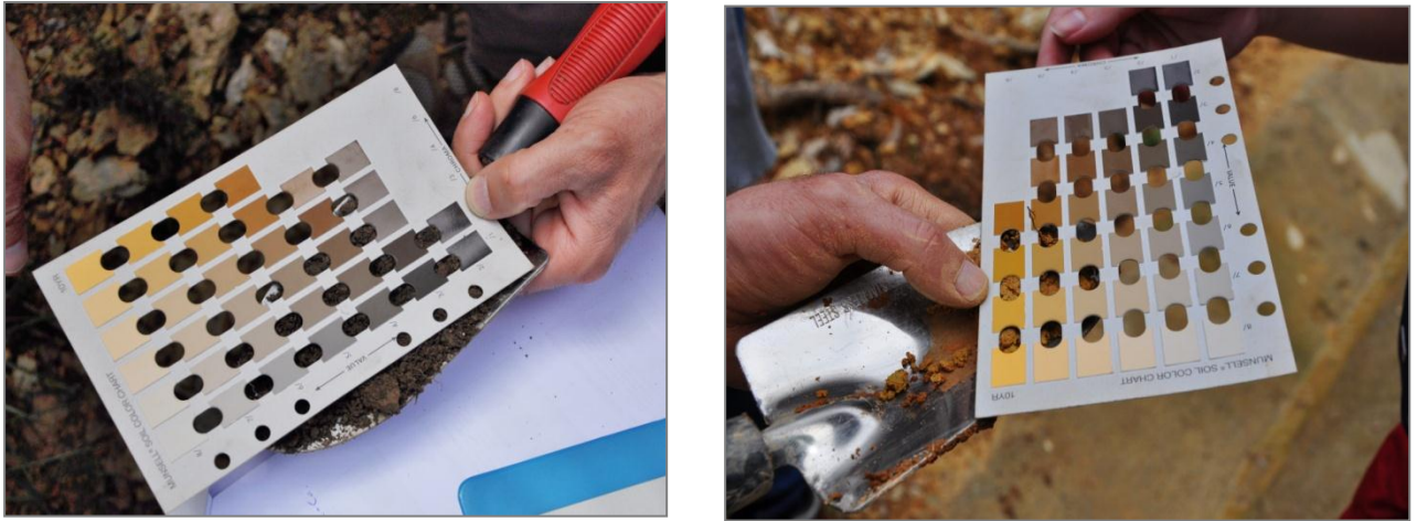
Figura 15. Determinação da cor do solo através da carta de cores de Munsell
