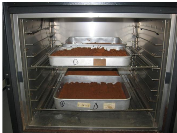
Figura 12. Amostras de solo superficial recolhidas nas proximidades do Ribeiro de Murta; Secagem de amostras na estufa
