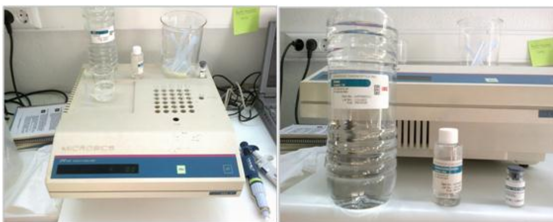
Figura 29. Microtox 500 Toxicity Analyzer; Reagentes utilizados no teste de toxicidade (diluyente e solução de ajuste osmótico).
