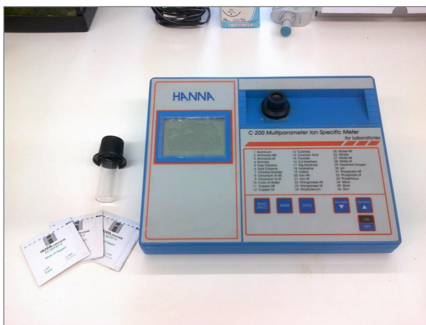
Figura 28. Fotómetro multiparamétrico, cuvete e kits de reagentes
