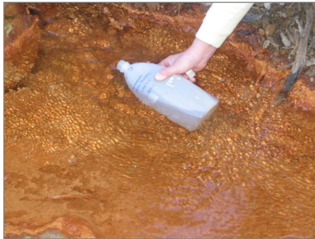
Figura 24. Recolha de amostra de água superficial no Ribeiro de Murta
