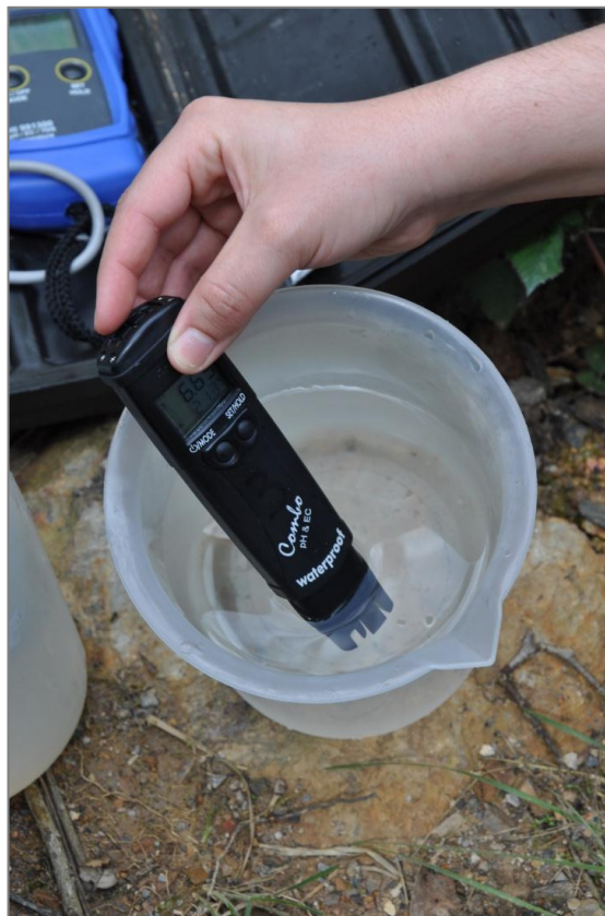
Figura 27. Medição de parâmetros físico-químicos no campo
