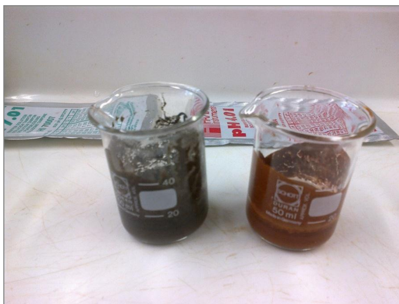
Figura 19. Mistura de água e solo na proporção 2:1
