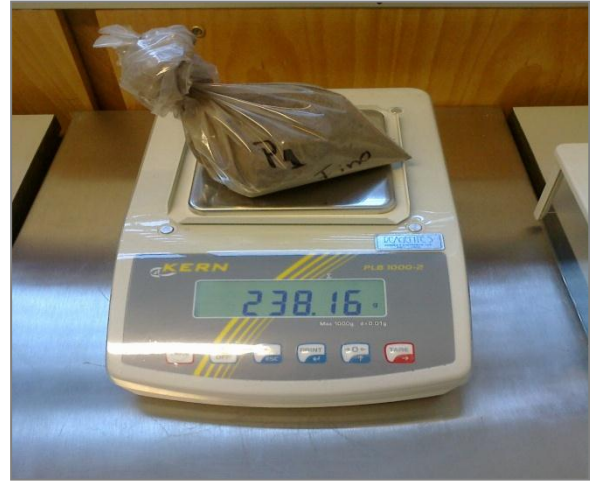
Figura 13. Separação granulométrica do solo; Pesagem do solo
