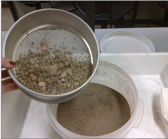
Figura 13. Separação granulométrica do solo; Pesagem do solo
