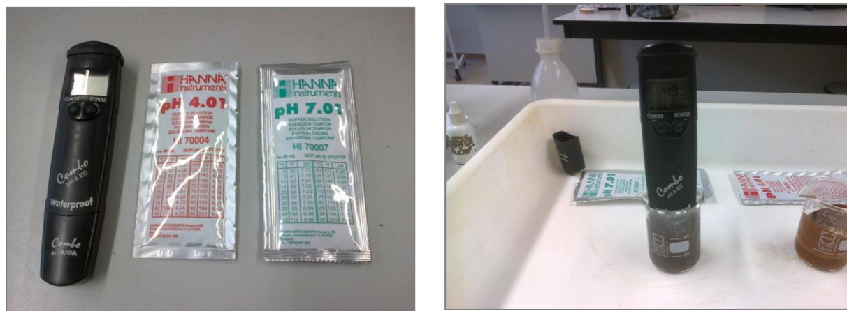
Figura 18. Medidor de pH e buffers; Medição de pH na mistura solo - água
