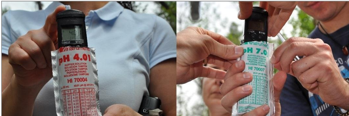
Figura 26. Calibração do medidor de pH
