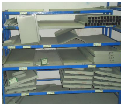
Figura 18 - Estante de armazenamento de materiais após a pintura, enquanto aguardam entrada do carro na linha
