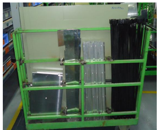
Figura 23 - Carrinho de abastecimento alterado, adequado aos materiais realocados
