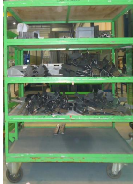
Figura 17 - Imagem de um carrinho destinado a movimentações de materiais da produção até à estufa de pintura
