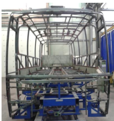
Figura 13 - Estrutura acoplada, Gaiola
