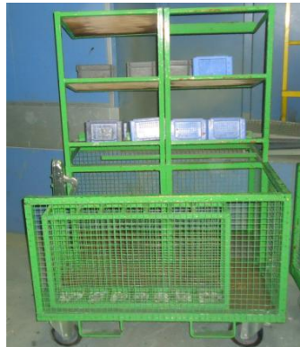
Figura 19 - Imagem de um carrinho destinado a movimentações de materiais da pintura ao posto de aplicação
