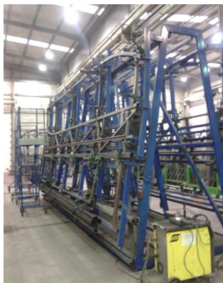
Figura 12 - Gabarit - Meio auxiliar de produção utilizado para montagem de um dos painéis de um autocarro
