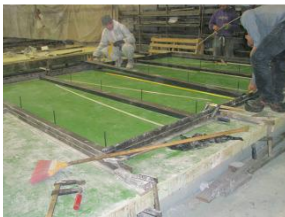
Fig. 5.9 – Montagem do molde do painel.
