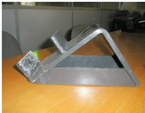
b) Amostra da cantoneira tipo 1 (fase de execução)
