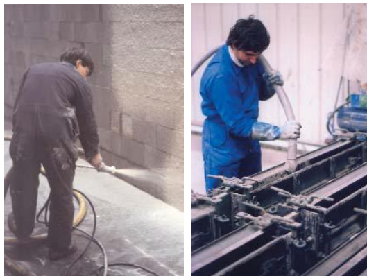
Fig. 2.12 – Processo de pré-mistura ( premix ) [7].
