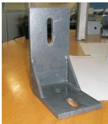
a) Amostra da cantoneira tipo 2 (fase de execução)
