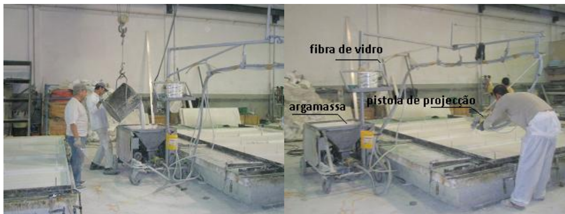
Fig. 5.12 – Produção dos painéis por projeção direta ( spray-up ).
