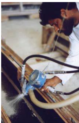
Fig. 2.11 – Processo de projecção direta ( spray-up ) [7].
