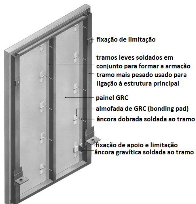
Fig. 4.12 – Fixação tipo de um painel stud frame [5].
