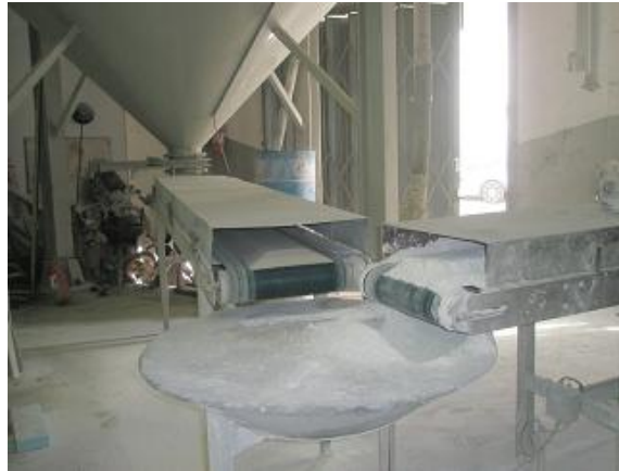
Fig. 5.6 – Realização da pesagem da mistura (balança automática).
