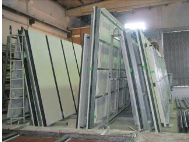
Fig. 5.19 – Armazenamento dos painéis na fase de pré-fabricação.
