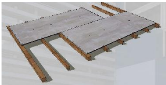
Figura 2.13 - Paineis viroc aplicada em pavimentos [6]
