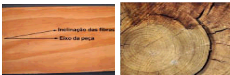
Figura 2.8 - Inclinação do fio, fendas [3]
