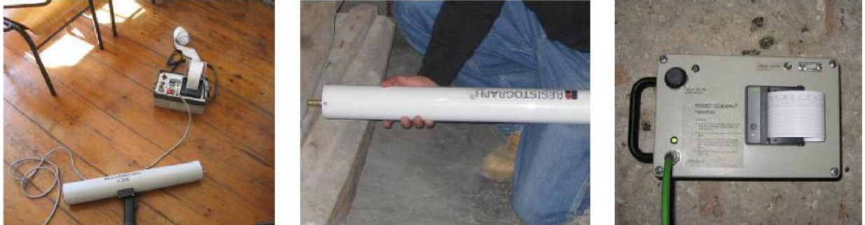
Figura 3.44 - Resistograph e dispositivo de recolha de dados (Ilharco, 2008)
