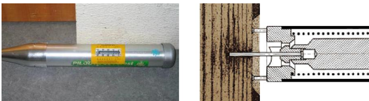
Figura 3.45 - Pilodyn e esquema de funcionamento (Ilharco, 2008)
