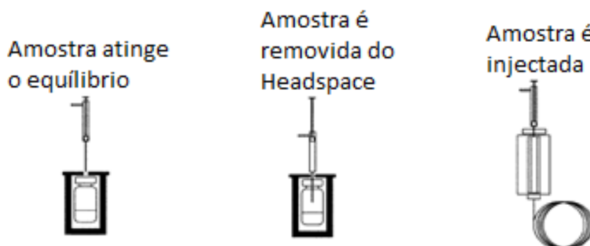
Figura 8: Esquema exemplificativo dos passos usuais na injeção de amostras na coluna cromatográfica em cromatografia gasosa
