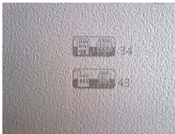
Fig.5.3. – Amostra de revestimento de piso vinílico com classificação da norma ISO 10874
