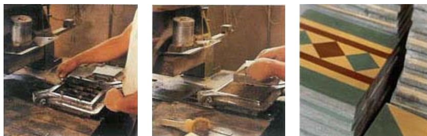
Fig.4.12. – Fabricação dos ladrilhos hidráulicos [34]
