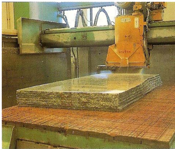
Fig.4.4. – Corte na máquina de Ponte automática [30]
