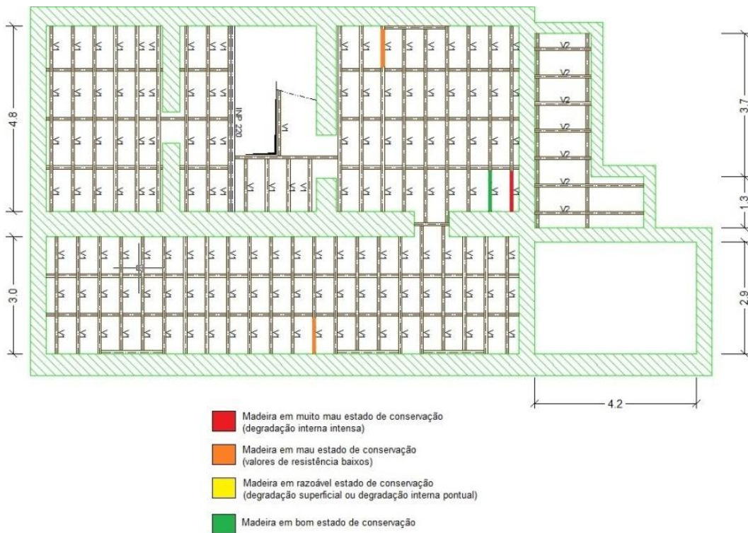
Figura 3.62 - Estado de conservação das vigas ensaiadas no nível 0 em 2011
