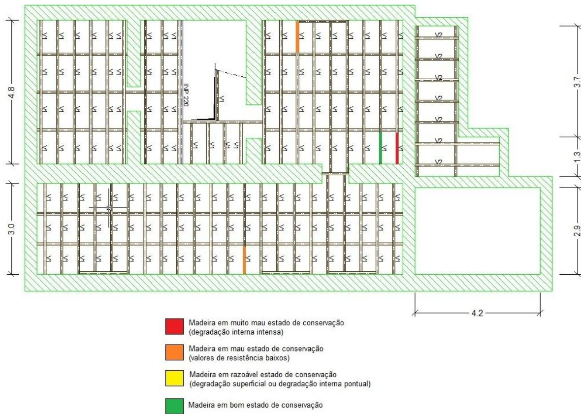
Figura 3.40 – Esquema de degradação das vigas de madeira do nível 0
