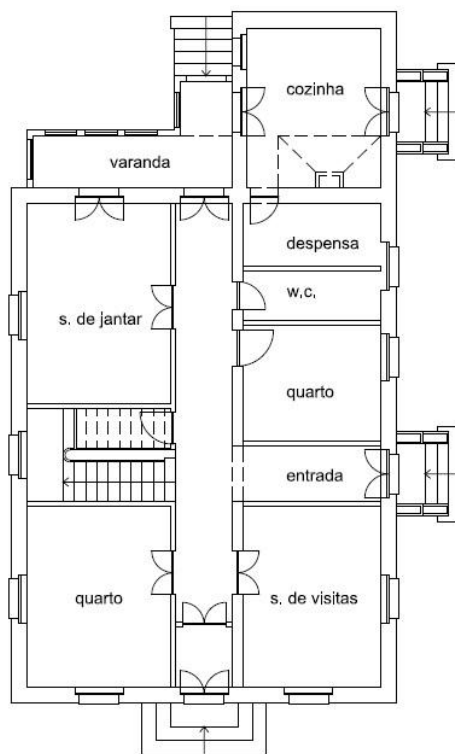
Figura 3.10 – Planta de arquitectura do piso 0
