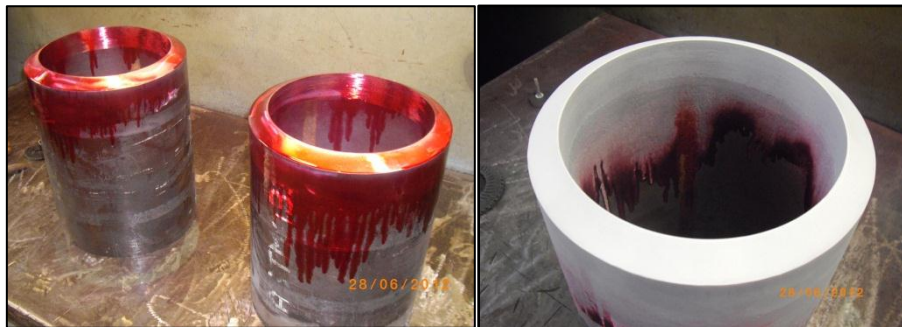
Figura 16 - Ensaio por líquidos penetrantes (à esquerda: penetrante, à direita: revelador)
