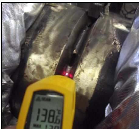
Figura 20 - Medição da temperatura entre passes com um pirómetro a laser
