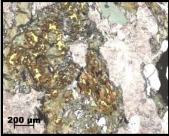
Fotografia 149. Imagem em N//. Cloritização de um agregado de biotite.
