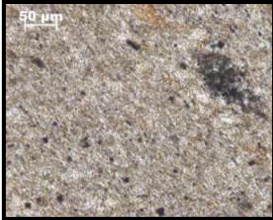
Fotografias 32 e 33. Imagem da esquerda em N// e imagem da direita em NX, ambas mostrando um argilito com minerais opacos.
