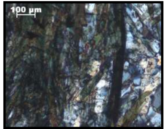
Fotografias 78 e 79. Imagem da esquerda em N// e imagem da direita em NX mostrando a forma alongada dos cristais de actinolite com cor esverdeada.
