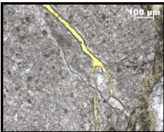
Fotografias 64 e 65. As duas imagens mostram o aspeto da micrite. Imagem em N// à esquerda e em NX a da direita.
