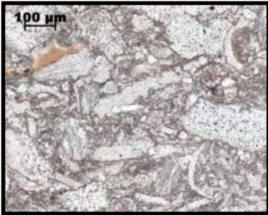
Fotografias 45 e 46. Na imagem da esquerda em N// são visíveis bioclastos calcíticos dispersos numa matriz micrítica. A imagem da direita em NX mostra o mesmo aspeto evidenciando as cores de polarização da calcite.
