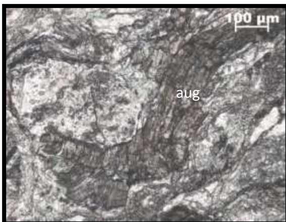
Fotografias 128 e 129. Imagem em N// à esquerda e em NX à direita. Cristais de augite (aug) contornando um porfiroclasto de feldspato com inclusões de epidoto.
