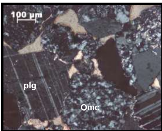
Fotografia 87. Imagem em NX. Plagioclases (plg) exibindo maclas polissintéticas. Clasto de rocha metamórfica composta por quartzo microcristalino (Qmc).
