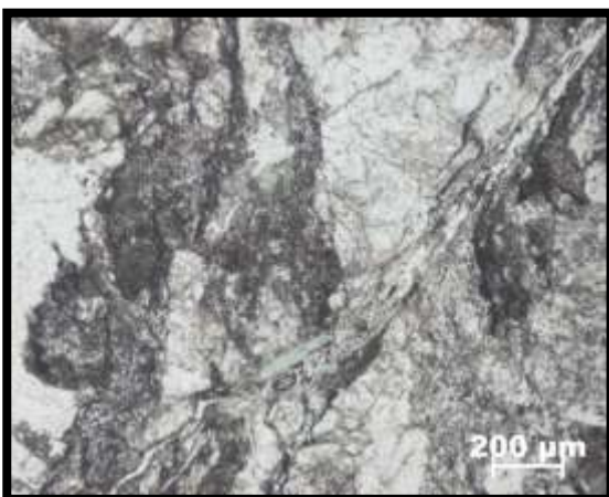
Fotografia 135 e 136. Imagem da esquerda em N// e imagem da direita em NX. Clasto de quartzo fragmentado, e quartzo micro e criptocristalino da matriz.
