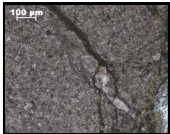
Fotografias 64 e 65. As duas imagens mostram o aspeto da micrite. Imagem em N// à esquerda e em NX a da direita.
