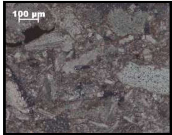
Fotografias 45 e 46. Na imagem da esquerda em N// são visíveis bioclastos calcíticos dispersos numa matriz micrítica. A imagem da direita em NX mostra o mesmo aspeto evidenciando as cores de polarização da calcite.
