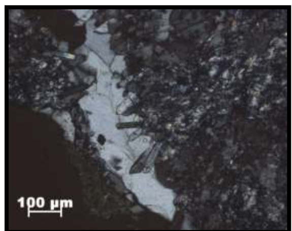
Fotografia 143 e 144. Imagem da esquerda em n// e imagem da direita em NX. Cristais de epidoto a crescer em veio preenchido por quartzo.
