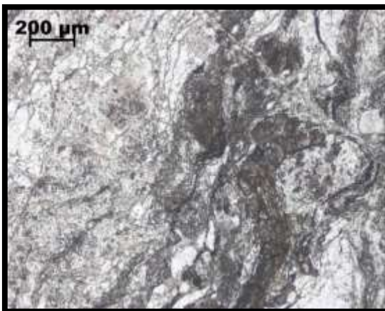
Fotografias 124 e 125. Imagem em N// à esquerda e em NX à direita. Matriz de sílica micro e criptocristalina circundando os clastos de feldspato.
