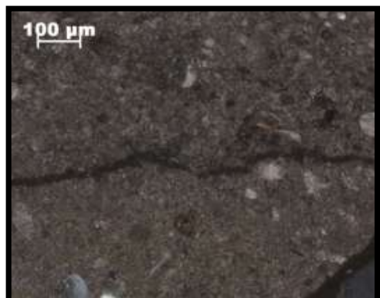
Fotografias 66 e 67. Imagem da esquerda em N// e imagem da direita em NX. Matriz micrítica com bioclastos dispersos.
