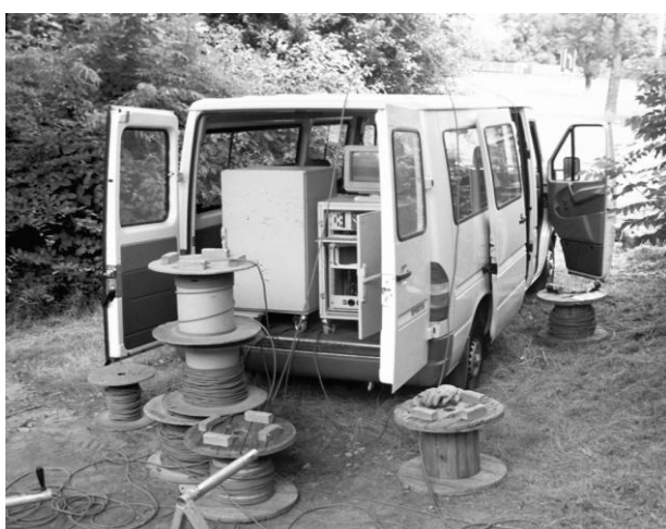
Fig. 2.2 – Equipamento para ensaio de vibração ambiental com recurso a sistema central de aquisição (Wenzel and Pichler 2005)
