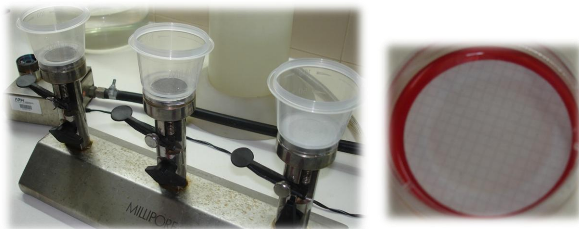
Fig. 17 – Rampa de filtração e membrana colocada sobre o meio de cultura
