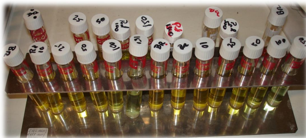
Fig. 12 – Cuvetes com as soluções das amostras de água para a determinação do CQO
