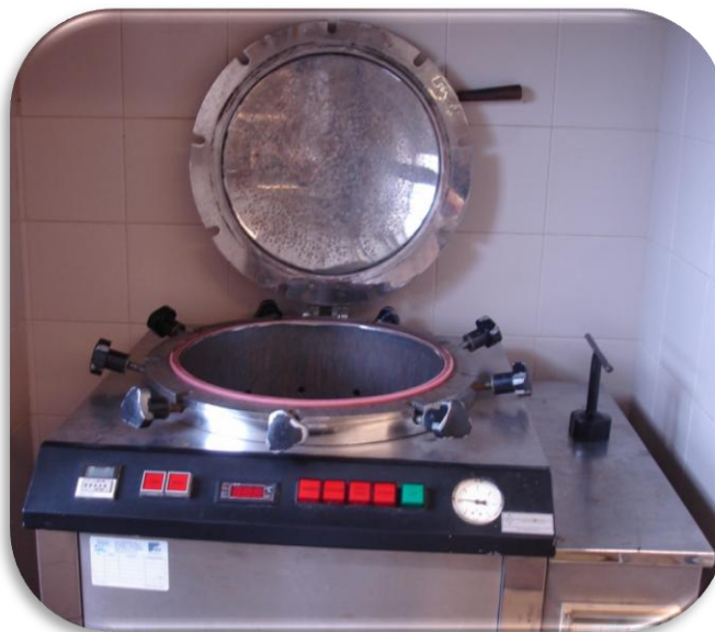
Fig. 2 – Autoclave para esterilização de material
