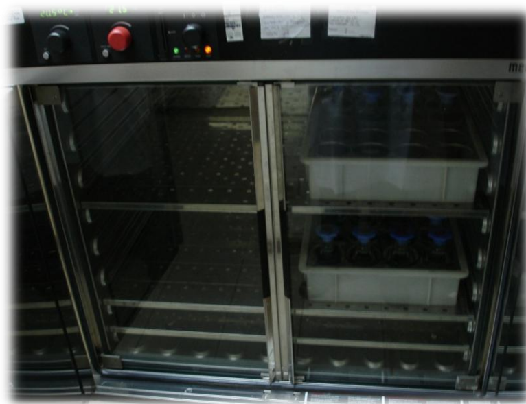
Fig. 7 – Estufa a 20 \pm 1^\circ C para incubar na obscuridade as amostras durante 5 dias
