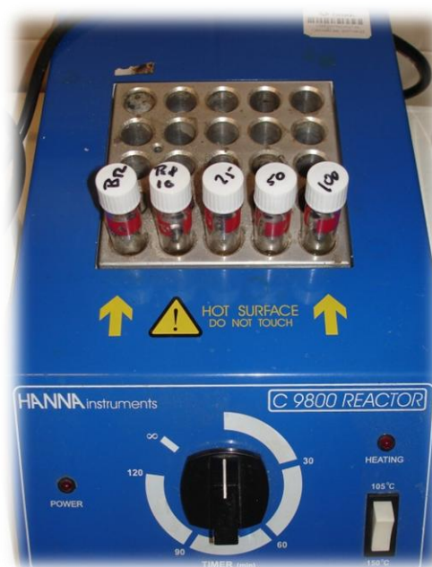
Fig. 13 – Aquecimento das cuvets no reator para a determinação do CQO
