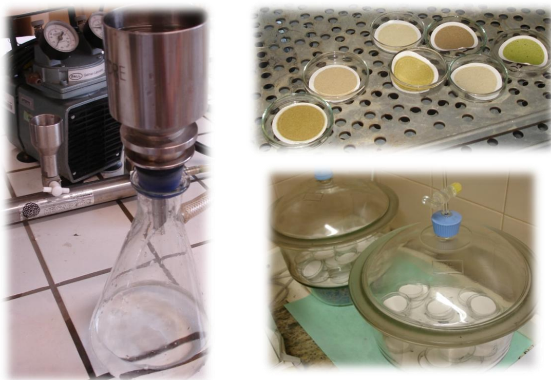
Fig. 16 – Filtração, secagem na estufa e arrefecimento no exsicador para posterior pesagem de SST
