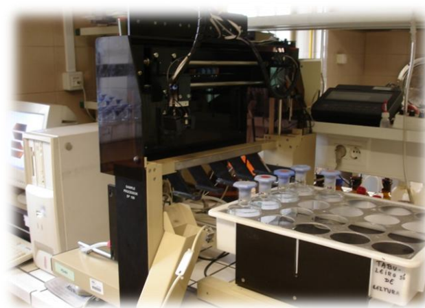
Fig. 8 – Aparelho SP100 para a determinação do CBO_5 por método potenciométrico
