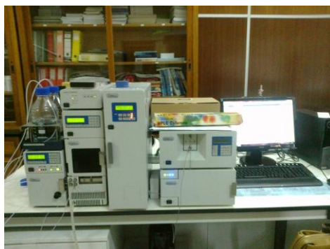
Figura 11: Sistema HPLC da Jasco (Japão) equipado com um injetor automático (AS-2057PLUS), uma bomba (PU-2089PLUS) e um detetor de fotodíodos (MD-2018PLUS) acoplado a um detetor de fluorescência (FP-2020PLUS)
