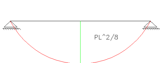
Fig. 40 – Diagrama de momentos (viga simplesmente apoiada)
