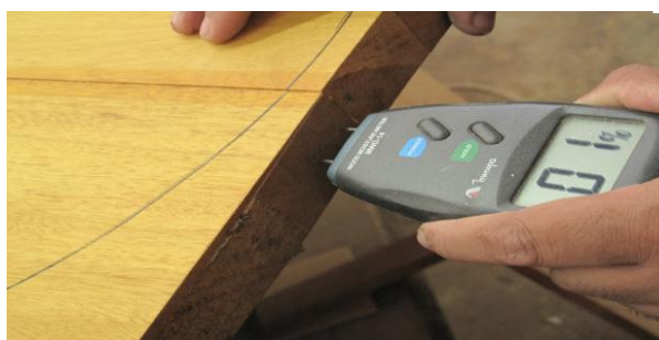
Fig. 5 – Medição da humidade da madeira
