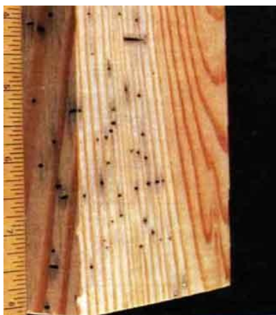
Fig. 6 – Tronco sujeito a ataque de fungos
