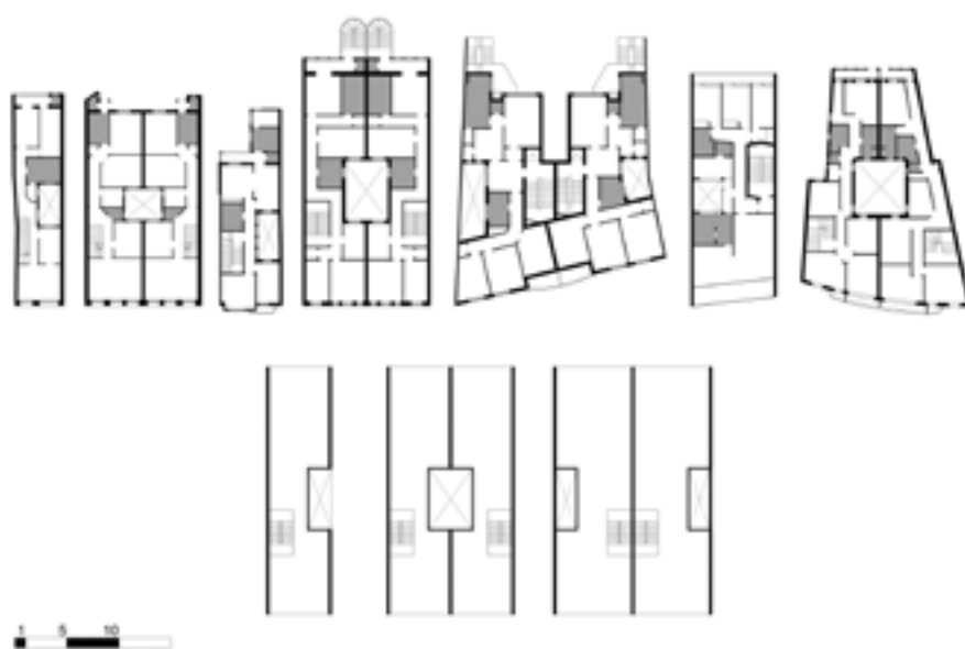
Fig. 5 – Modelos a partir do “tipo estreito e profundo”, com saguão e escada paralela à parede de meação. Duplicação; simetria; deformação; adaptação às particularidades do lote e procura de edificabilidade máxima. Da esquerda para a direita, esquemas produzidos a partir das Licenças de Obras 1930-0328; 1929-0644; 1944-0281; 1938-1052; 1936-1471; 1954-0094; 1938-0076 (Arquivo Histórico da Câmara Municipal do Porto), (desenhos da autora)
