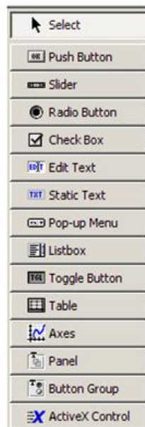
Figura 3.9 – Componentes de uma Interface Gráfica em Matlab.
