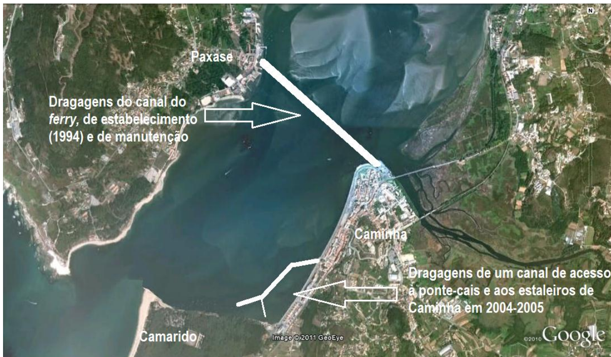
Fig.3.10 – Localização das dragagens no canal e no acesso ao cais de Caminha (imagem do earth.google.com complementada com informação do LNEC, 2007).
