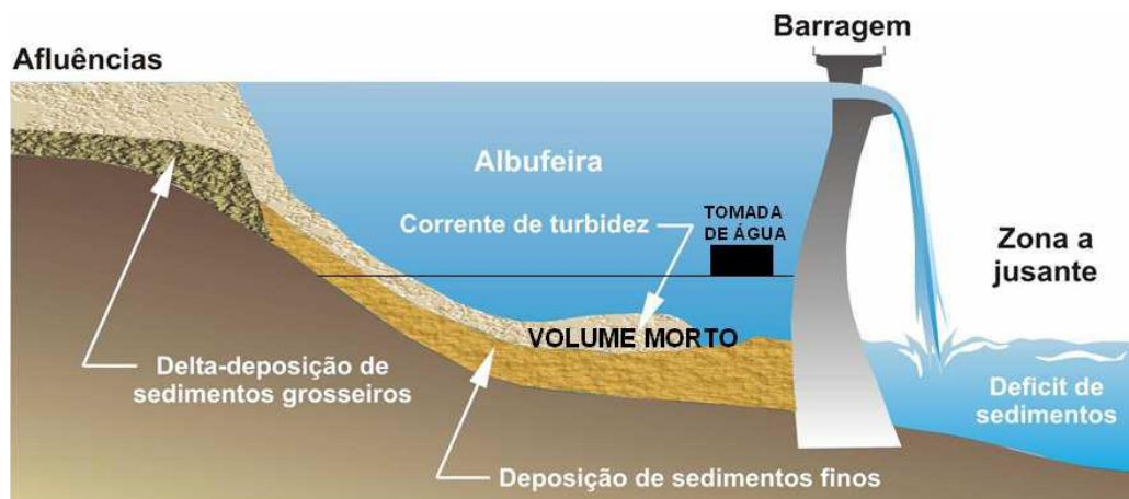
Fig.2.13 – Padrão típico de deposição do sedimentos nas albufeiras (Lameiro, 2009).
