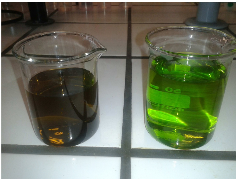
Figura 10 - Efluente da Eurogalva (banho de decapagem) antes e depois da redução de \text{Fe}^{3+} a \text{Fe}^{2+} , respetivamente.
