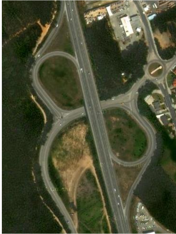
Fig.2 – Vista aérea de um nó de ligação em trevo incompleto (Fonte: Google Maps)
