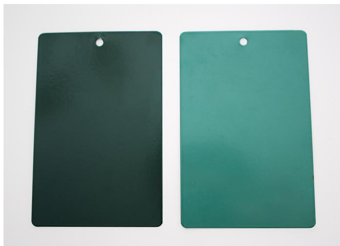
Figura 8 - Suporte com tinta a) antes e b) após o teste de absorção de água (imagem relativa ao ensaio 11)
