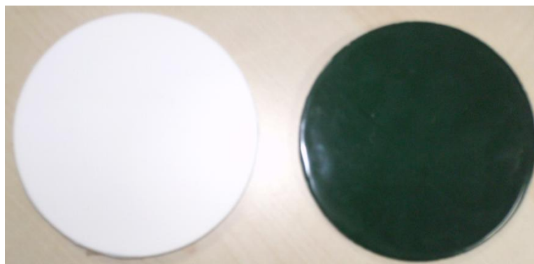
Figura 12 - Placa cerâmica a) original e b) após aplicação da amostra de tinta em estudo [17]
