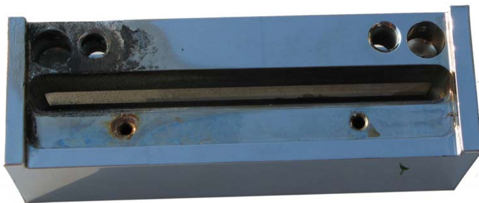
Figura 5.24 – Corrosão galvânica num bloco de alumínio
