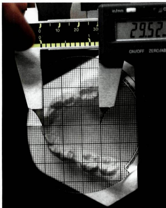
Figura 10 – Medição da profundidade da arcada. A colocação do paquímetro tal como está na figura foi para facilitar a sua visualização.
