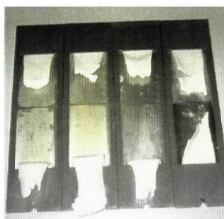
Figura 10.1 Amostras de geotêxtil B00 expostas a radiação UV de energia 35 MJ/m 2
