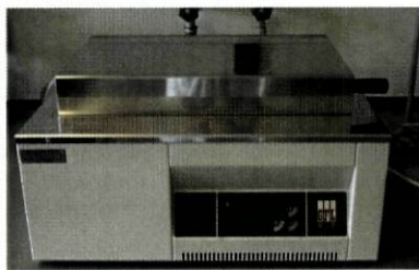
Figura 7.1 Banho termostático utilizado para a imersão dos materiais
