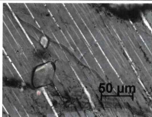
Fig. 3.6: Cristal de feldspato potássico pertítico com apatite (NX).
