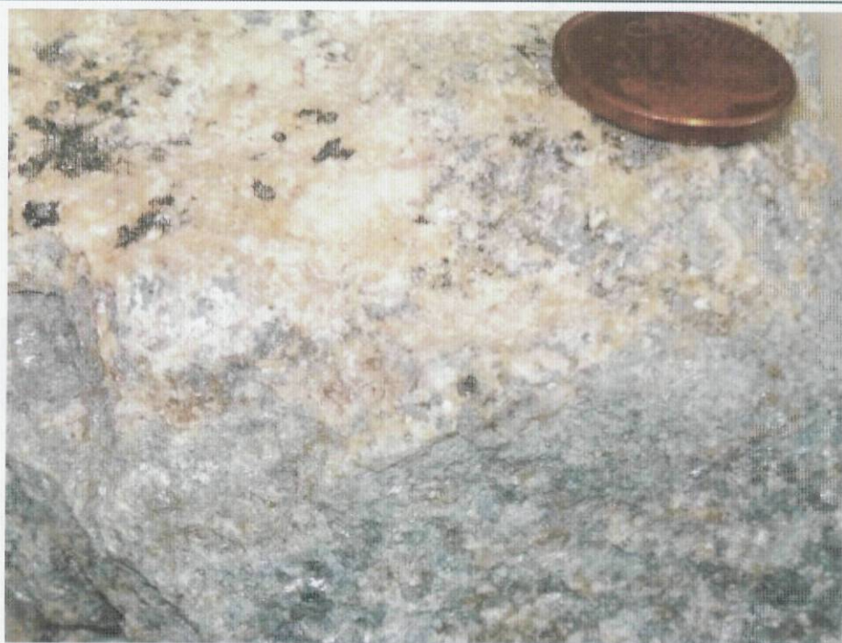
Fig. 3.16: Zona fosfatada azul (cor dominante dentro da fácies F). No canto superior esquerdo da imagem observa-se uma zona de cor branca que corresponde a fácies L e cristais escuros de vivianite.
