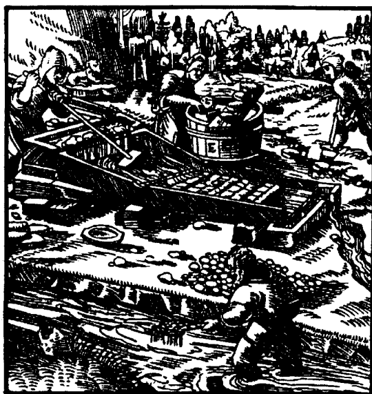
Figura 4.23. – Mesa de lavagem utilizando urze como cobertura para retenção do minério (AGRICOLA, 1556).
