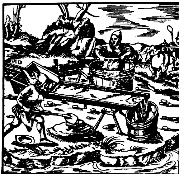
Figura 4.24. – Mesa de lavagem utilizando tecido ou pele como cobertura para retenção do minério (AGRICOLA, 1556).
