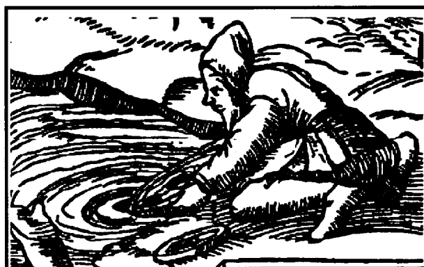
Figura 4.2. – Utilização da bateia para a lavagem e concentração do ouro (AGRICOLA, 1556).
