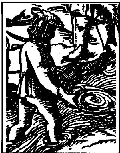
Figura 4.1. – Utilização da bateia para a lavagem e concentração do ouro (AGRICOLA, 1556).
