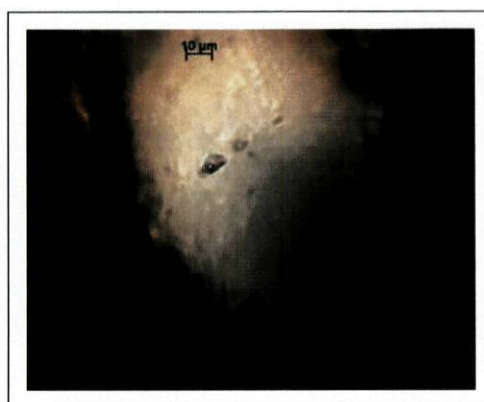
Figura 5.6 - Fotografia microscópica da amostra de quartzo da Fonte da Cal. Observação em nicóis paralelos. Ampliação 50x de objectiva e 10x/22CM de ocular.
